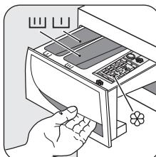
Щ Отделение для порошкового или жидкого моющего средства, используемого при основной стирке. При использовании жидкого моющего средства наливайте его **непосредственно перед запуском программы**.
