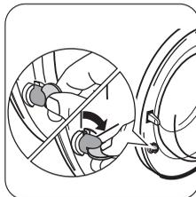
**Для включения** этого устройства поверните по часовой стрелке кнопку с внутренней стороны дверцы (не нажимая ее) так, чтобы паз пришел в горизонтальное положение. При необходимости используйте для этого монету.
