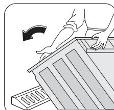
После снятия всей упаковки положите машину на заднюю панель, чтобы вынуть полистироловую прокладку из ее основания.
