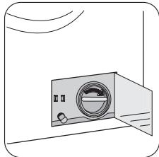
Закрутите крышку фильтра до упора. Закройте дверцу фильтра сливного насоса.
