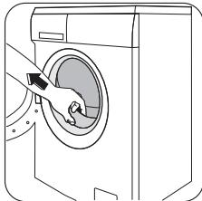
Откройте дверцу машины и снимите полистироловую вставку, прикрепленную к прокладке дверцы.
